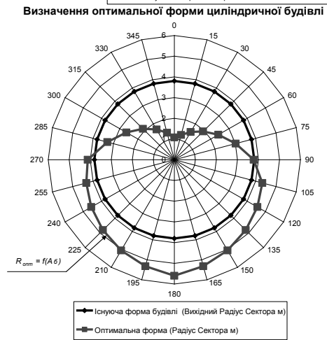
Рис. 4. Модели определения оптимальной формы здания и перераспределения утеплителя
